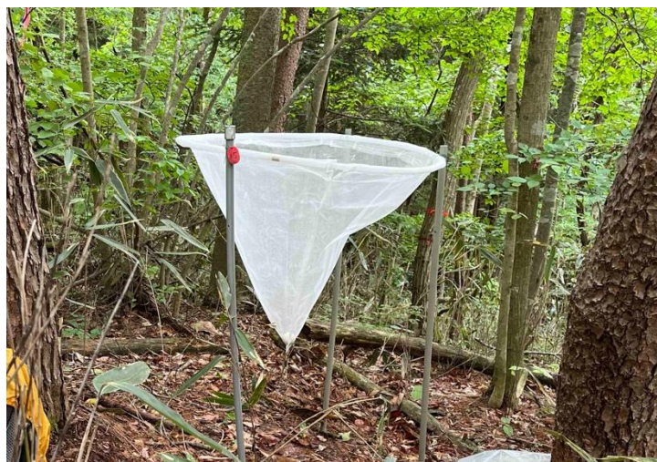
写真 7.1.-1 落葉・落枝回収に使用したリタートラップ（館山アカマツ林試験地）
