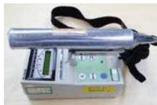
シンチレーション検出器(電離放射線を測定する測定器)。簡易型のガンマ線線量率計として広く用いられています。
