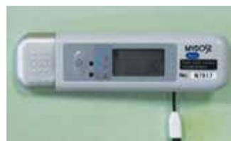
電子式線量計。ポケットに差して使用できるγ(X)線線量計として個人被ばくの測定に使われます。
