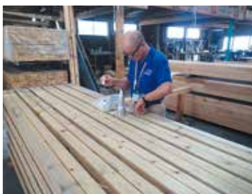
【写真】木材の表面線量測定状況
