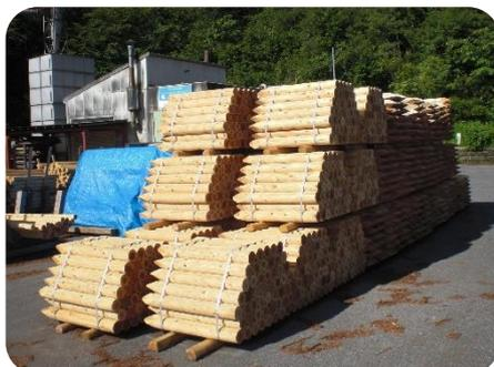
丸棒加工製品 (丸太筋工)
