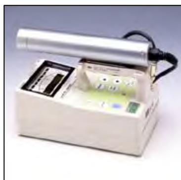
写真 4-1 NaI(Tl)シンチレーション式サーベイメータ外観
