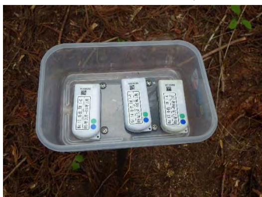
D-シャトル設置状況
