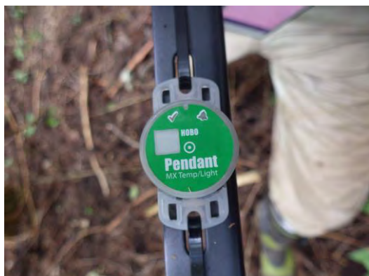
照度計設置状況近景
