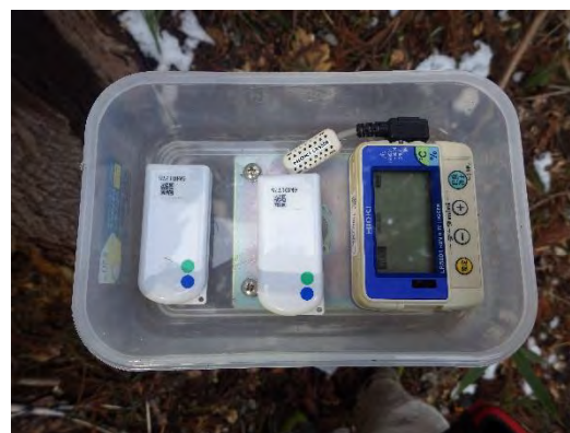
温湿度計設置状況
