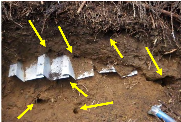
ライシメータ周辺に掘られたモグラの穴(左)と地表付近に掘られたモグラの穴(右) 写真 4-17 モグラによるゼロテンションライシメータへの被害状況(高倉事業地)
