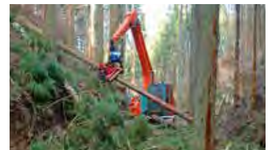
写真 作業機械の使用が被ばく低減に効果的
