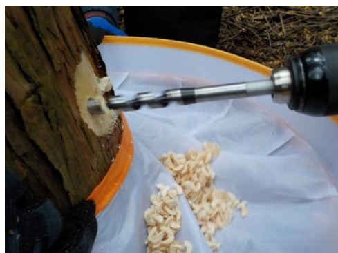
ドリルビットを使用した材の採取の様子
