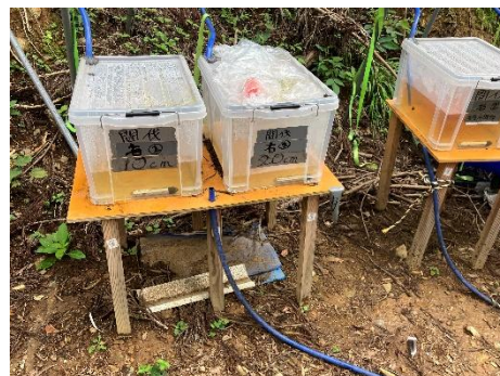
浸透水集水状況
