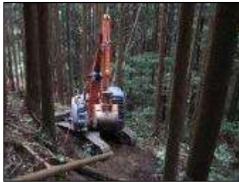
バケット付バックホウ （ウインチ付き）
