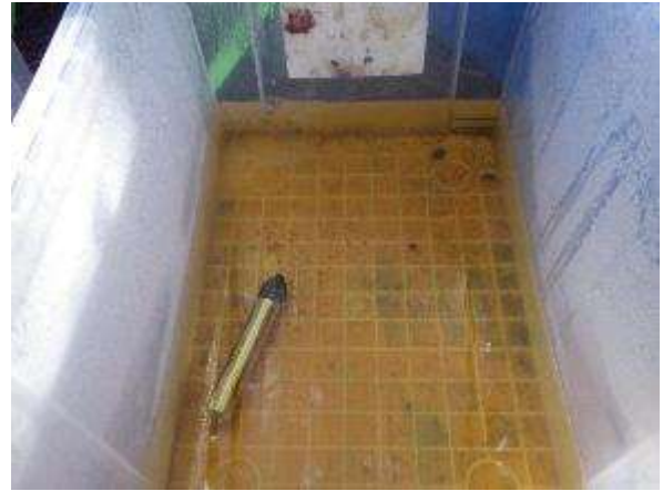
浸透水採水タンク・自記水位計
