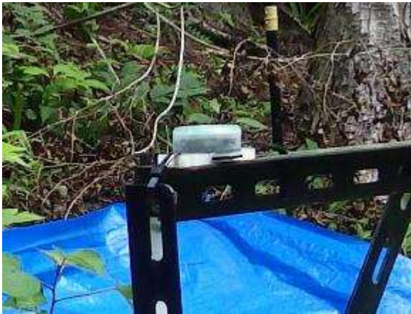
照度計設置状況（近景）
