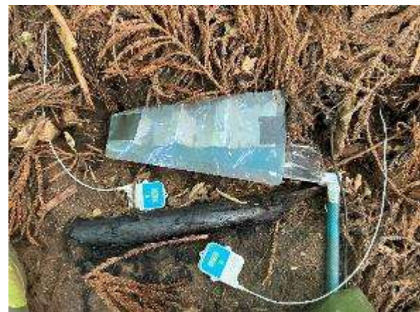
地温計設置状況
