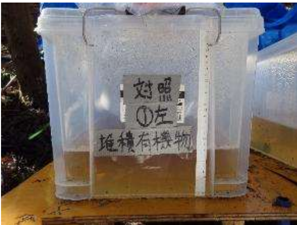
浸透水採水タンク (45L)
