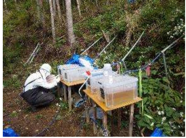
浸透水集水状況
