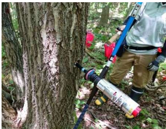
写真 5-8 成長錐を用いた木材コアの採取
