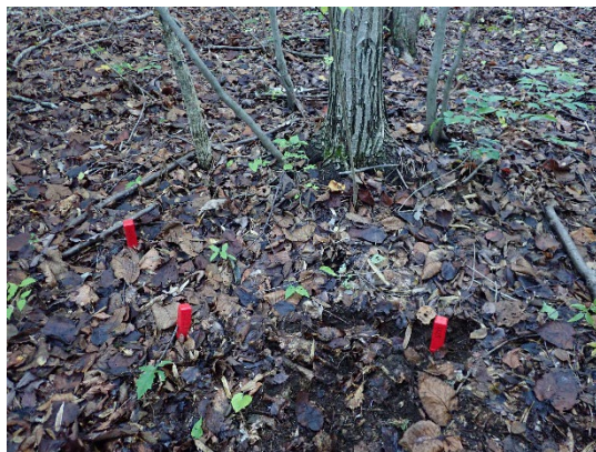
写真1 2025年度と過去2回（2021年度、2023年度）の土壌試料の採取地点を示す赤杭
