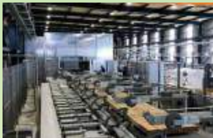
●高出力高周波プレスによる積層接着
