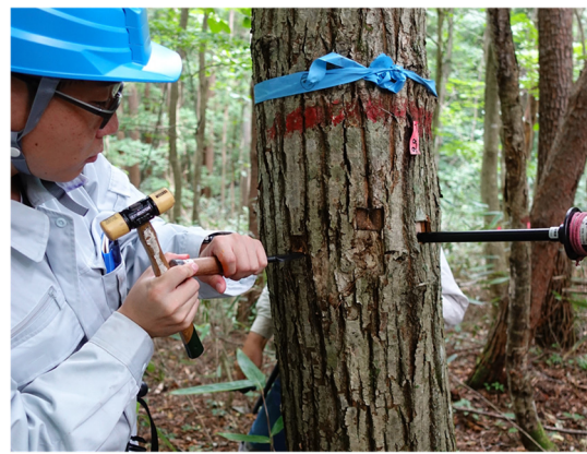
写真 5.-6 ノミを用いた樹皮の採取
