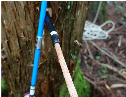
写真 5.-7 成長錐を用いた木材コアの採取
