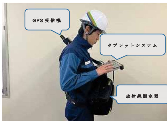
写真 5.2 放射線測定器外観及び使用状況
