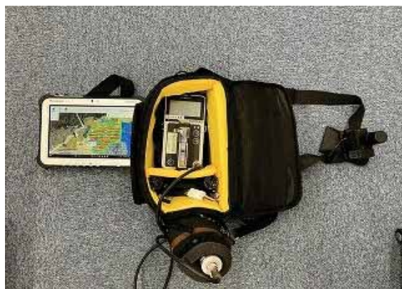
写真 5.2 放射線測定器外観及び使用状況
