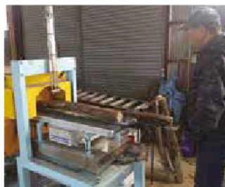
写真1 きのこ原木の放射性セシウム濃度検査
