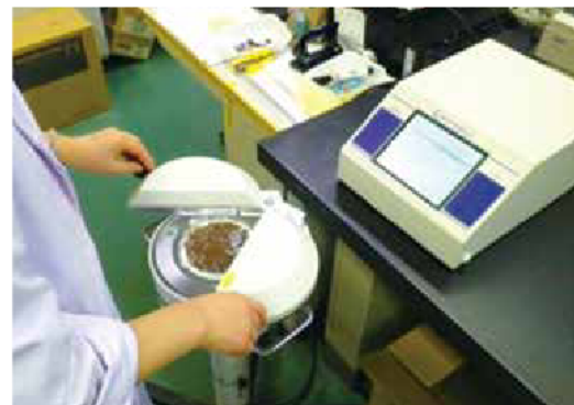
写真2 放射性セシウム濃度の測定検査の様子
