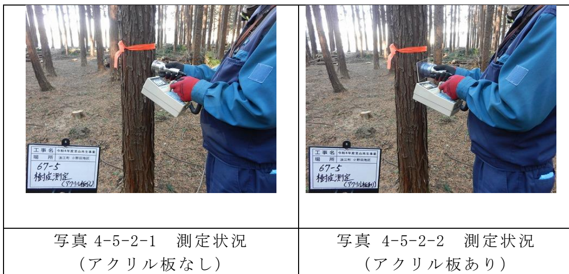
図 4-5-2-1 表面計数率の測定方法と考え方
