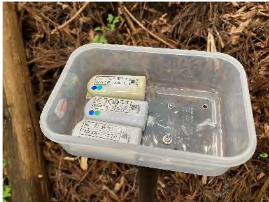
D-シャトル設置状況
