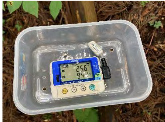
温湿度計設置状況
