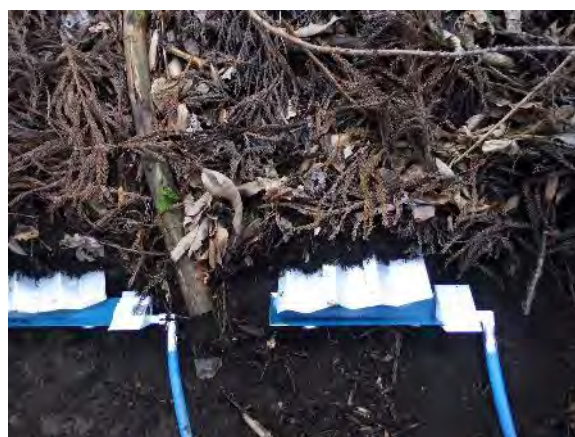
トタン水受けと 3D プリントで作成した治具を設置
