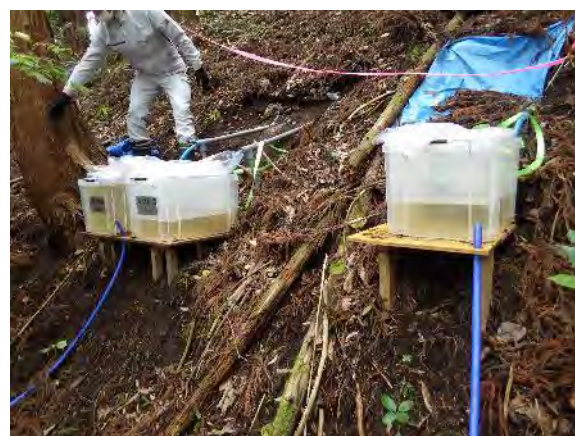
浸透水集水状況
