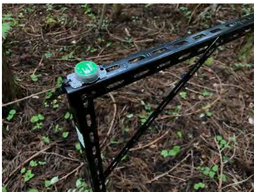
照度計設置状況近景
