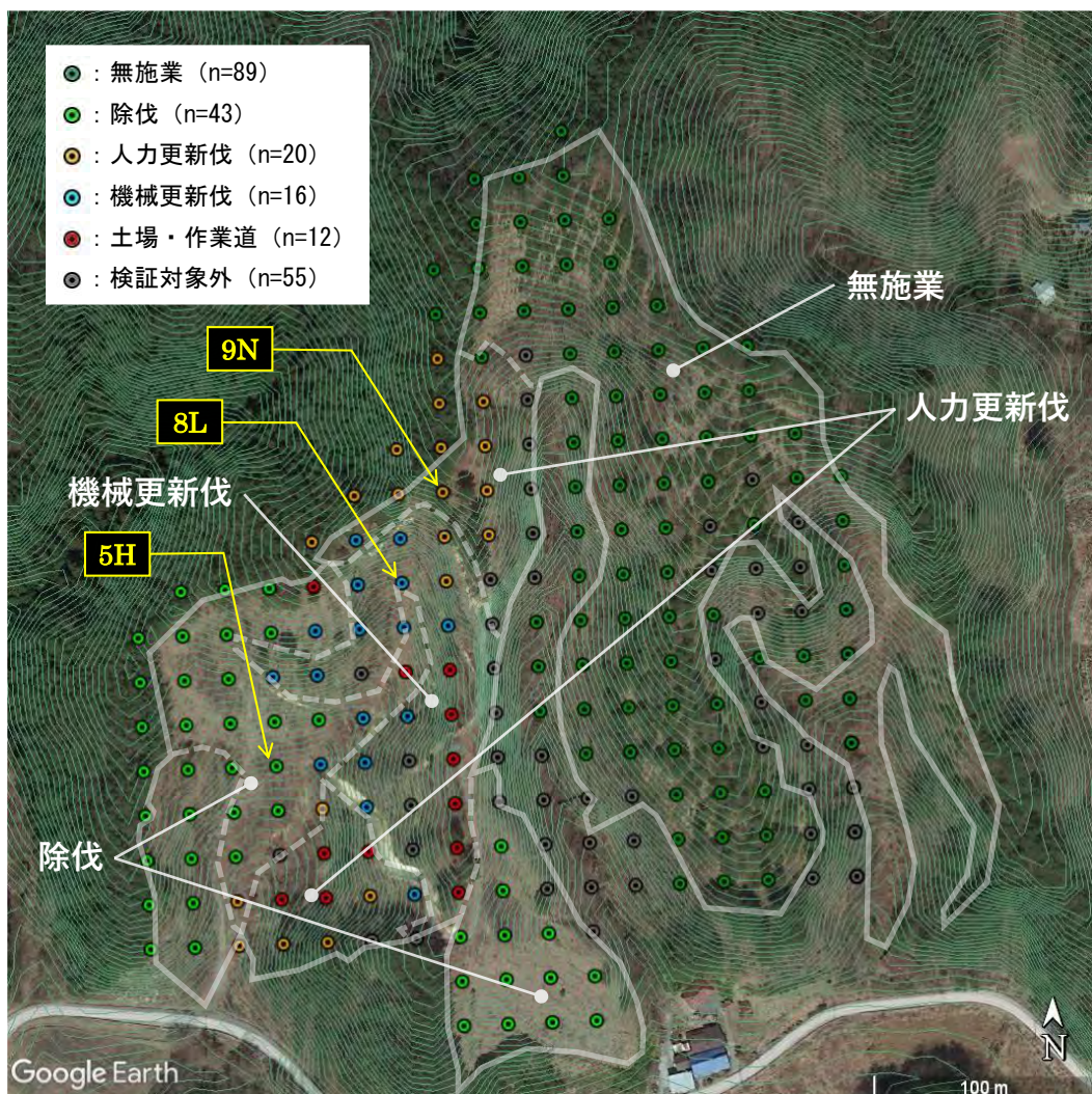
図 2-18 小滝沢事業地空間線量率測定点
