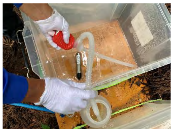
ゼロテンションライシメータ浸透水試料回収状況
