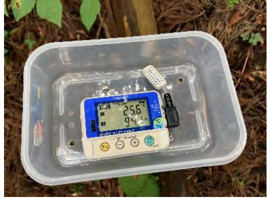
温湿度計設置状況
