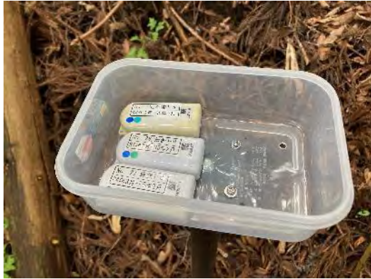
D-シャトル設置状況
