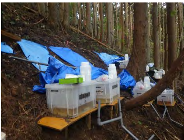
ゼロテンションライシメータ浸透水試料回収状況
