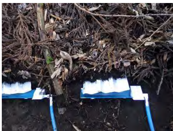
トタン水受けと 3D プリンタで作成した治具を設置
