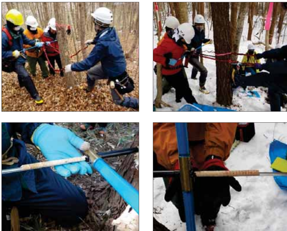
写真 3-5 径 12mm の成長錘をスマートボーラーにより貫入させ材をサンプリング
