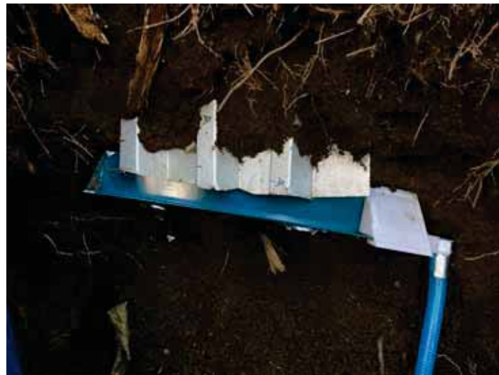
トタン水受け、3D プリンタで作成した治具を設置
