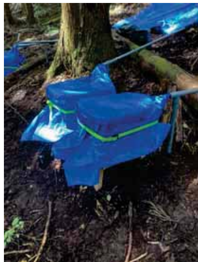
浸透水採水タンク保護状況
