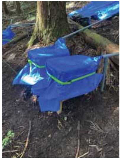
浸透水採水タンク保護状況
