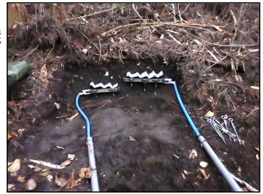
ライシメータ設置状況
