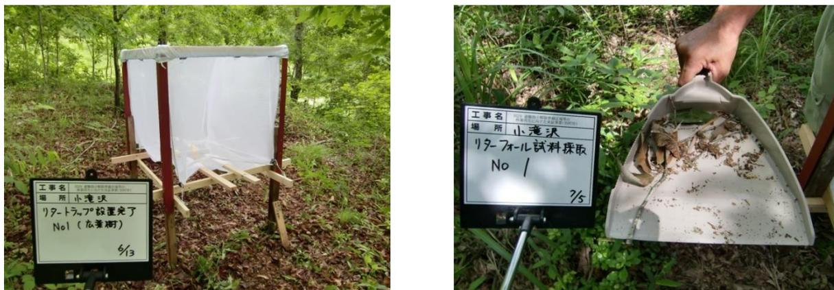
写真 5-3 リタートラップ（左：設置状況 右：試料採取）
