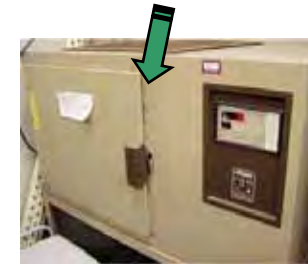
サブサンプルを乾燥させ乾重を測定。 (写真は温風式乾燥機)
