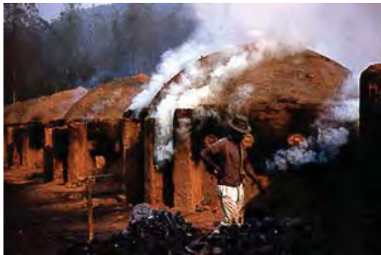
写真 8：従来の炭焼き窯（ブラジルのいくつかの地域で使用されている） （写真は Plantar 社提供）
