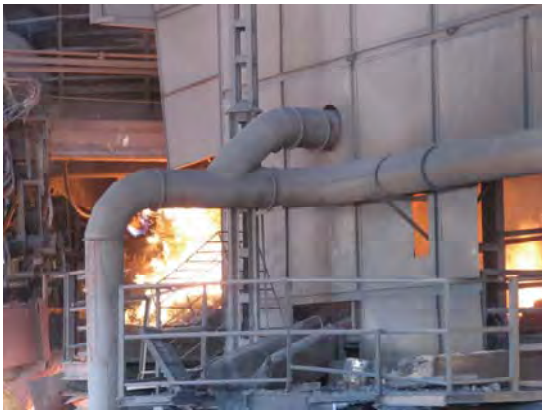
写真 90 : Pig Iron (銑鉄) 製造工程 100%木炭を還元剤として使用している。
