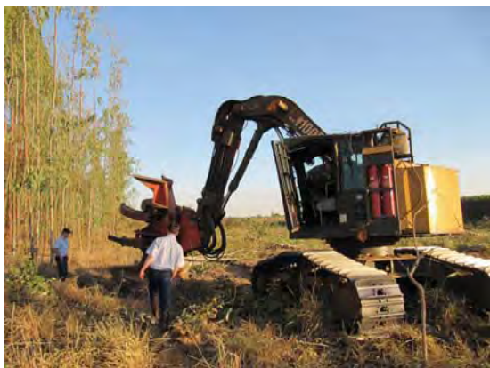
写真 49 & 50 : 伐倒作業はフェラーバンチャーを使用して行い、機械化による作業が進んでいる。(MG02)
