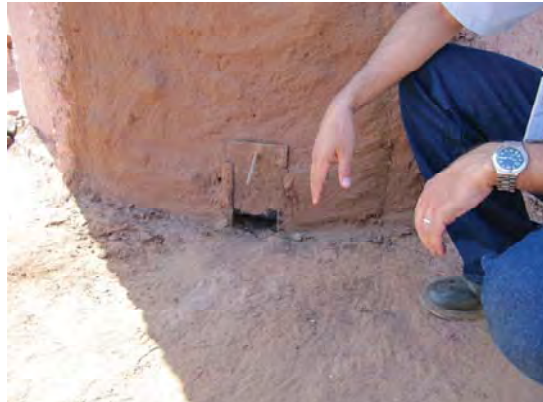
写真 66 : 通気口で窯へ吸入する空気の量を調整する。
