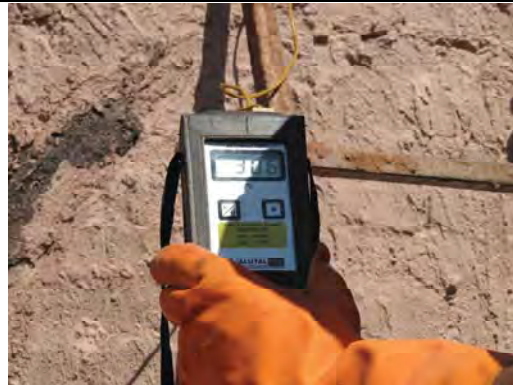
写真 68：窯を開けるのは午前 6 時で、窯の中の温度が 35℃以下になると開ける。これを超えた温度では、窯を開けた途端に炭は燃え尽きてしまう。
