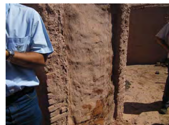
写真 65 : 原木を窯に入れ終わると入口を完全に塞いで密閉する。
