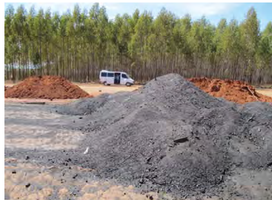
写真 70：木炭の粉は以前に廃棄していたが、現在は高压で炉に吹き込み使用している。
