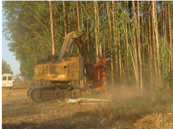
写真 49 & 50 : 伐倒作業はフェラーバンチャーを使用して行い、機械化による作業が進んでいる。(MG02)
