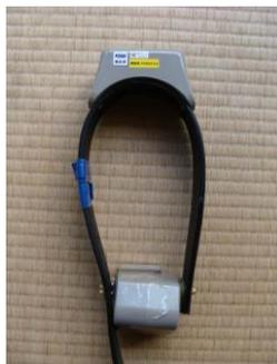
写真 3-1-1 Vectronic 社製 GPS 首輪 Vertex
