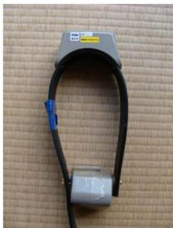
写真 3-1-1 Vectronic 社製 GPS 首輪 Vertex
