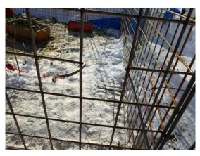
写真 4-13 弾があたって破損した格子
