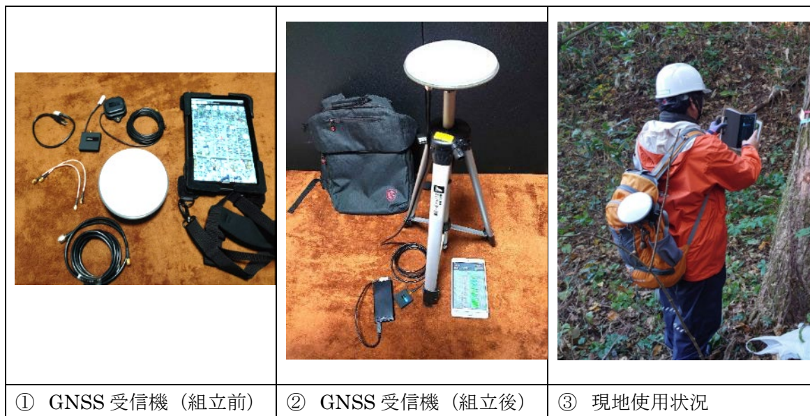
図 6-3. DG-PRO1RWS を用いた非健全木探査の様子
