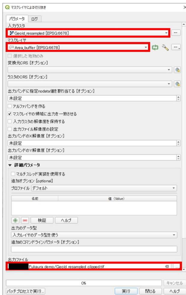
「マスクレイヤによる切り抜き」を使用して Geoid\_resampled を Area\_buffer で切り抜きます。出力ファイル名は Geoid\_resampled\_clipped.tif とします。
