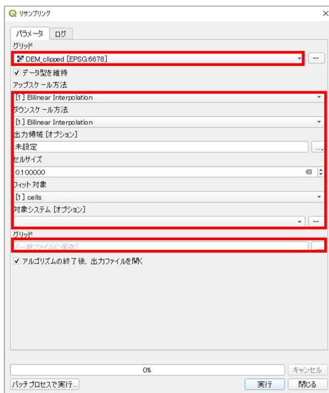
グリッド欄には DEM\_clipped を指定します。アップスケール方法とダウンスケール方法はともに[1]Bilinear Interpolation、セルサイズは0.1、フィット対象は[1]cellsにそれぞれ設定します。この処理では直接 tif ファイルを保存できないので、いったん一時ファイルに保存します。
