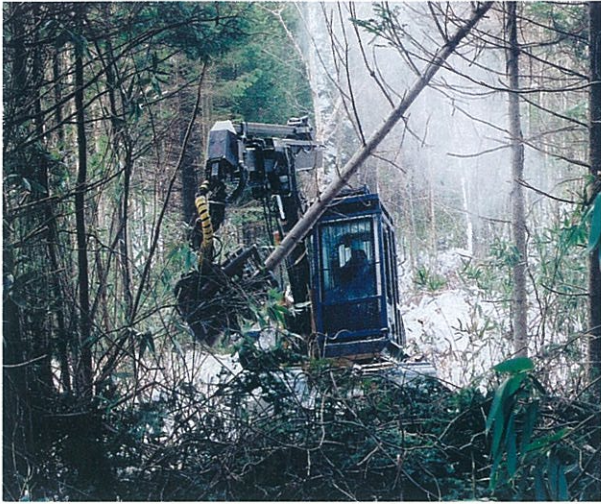
(ハーベスタによる伐倒・造材)
