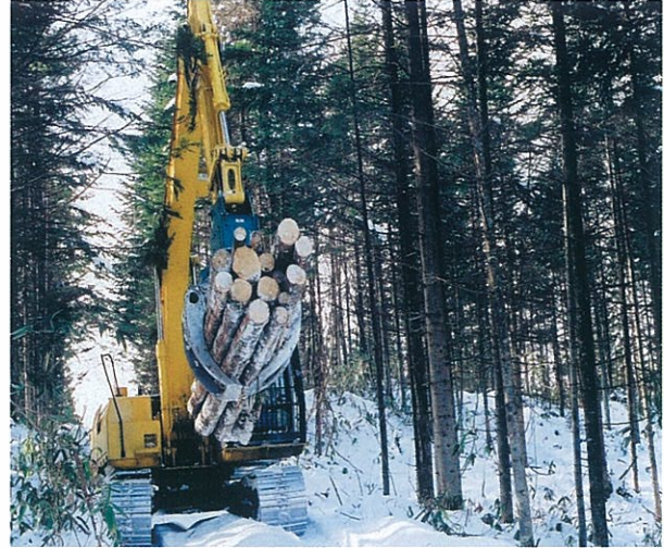
(グラップルによる集材・積み込み)
