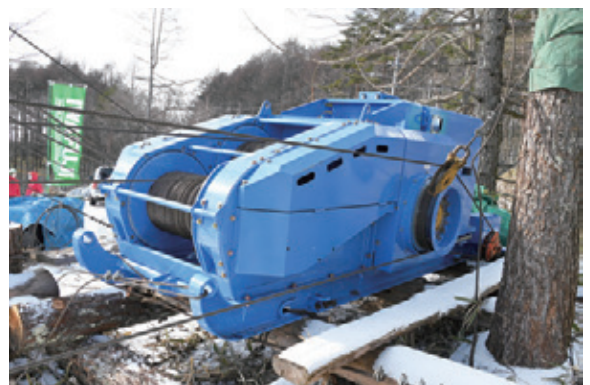
油圧式集材機。リフティングライン、ホールバックライン、エンドレスラインが巻いてある
