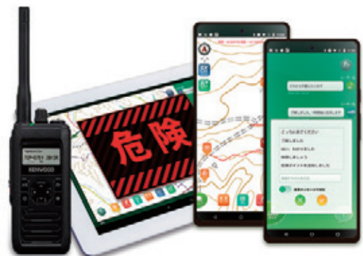
デジタル簡易無線によって、携帯電話の電波が届かない林内でも音声通話・データ通信が可能
