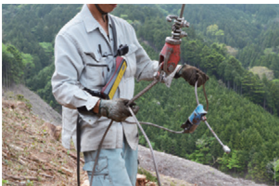
オートチョーカー（青い器具）。造材手がキャビンの中からリモコンで荷外しが可能
