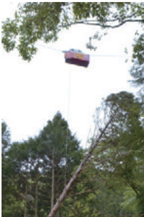
ウッドライナー内蔵の荷上げ索で吊り上げる
