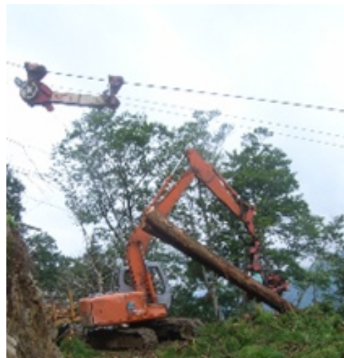
架線による集材とプロセッサによる造材
