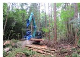
ハーベスタによる伐倒及び造材
