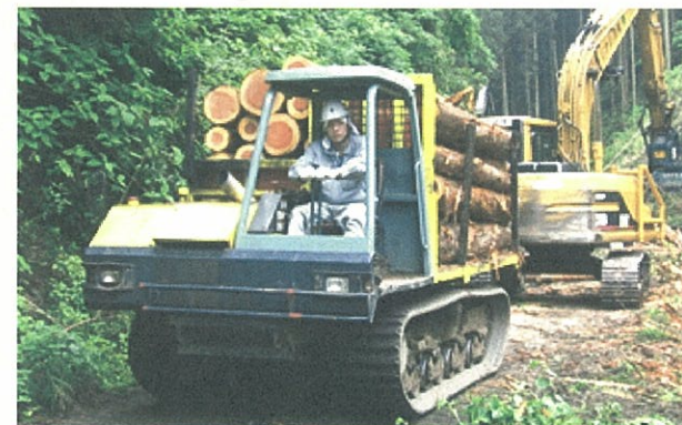
運材は大型フォワーダの活用により効率的に行います。
