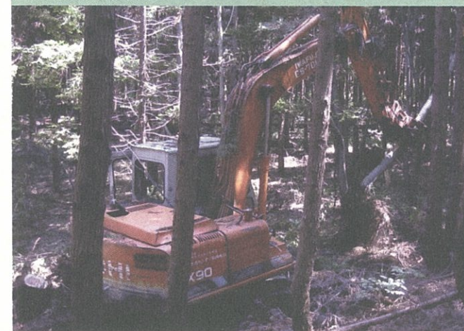
左写真:グラップルによる作業路の開設風景 右写真:開設した作業路
