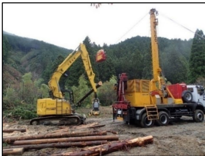
左 写真1 欧州製タワーヤダ、自走式搬器で下げ荷集材、ハーベスタ造材
