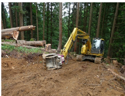
写真1 作業道に全木集材し、枝払い、造材
