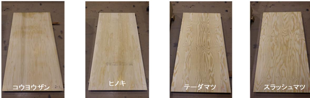
写真 2 試作した早生樹合板
