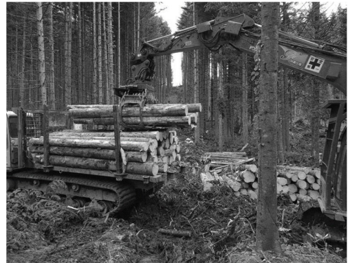
写真7 高性能林業機械による間伐作業
