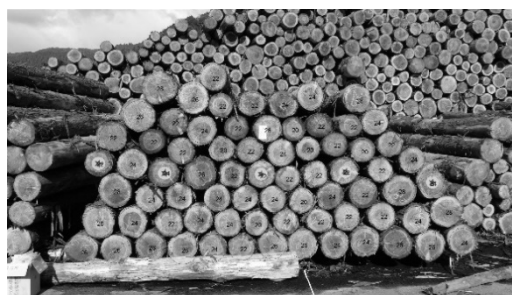
写真－2 検知丸による検知状況
