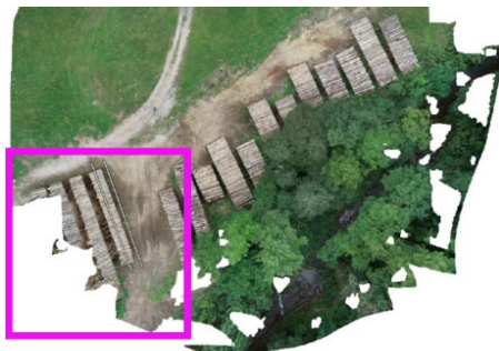
図-11 撮影範囲不足している例
