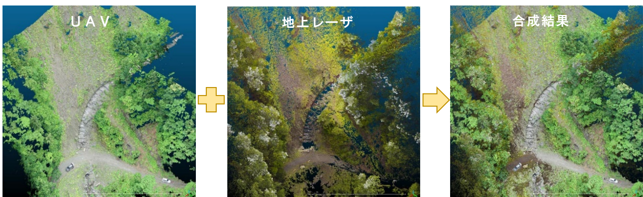
図-16 UAVと地上レーザの3次元点群データの合成
