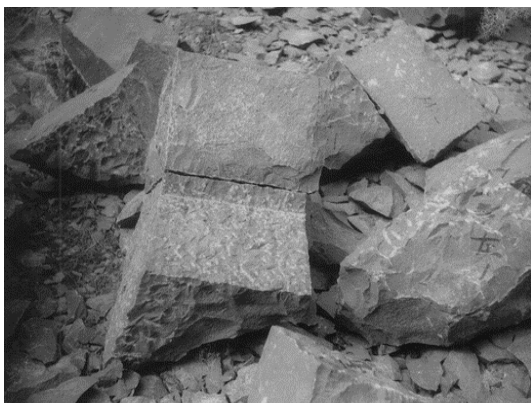
写真 4 張石（堰堤工に使用）
