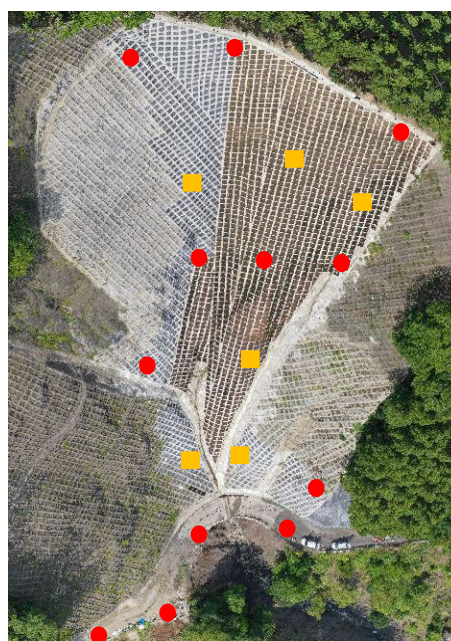
(写真-8) 標定点、検証点の設置位置
