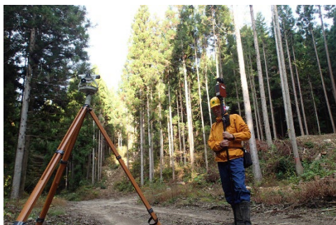
写真－1 コンパス測量との 樹高比較による検証
