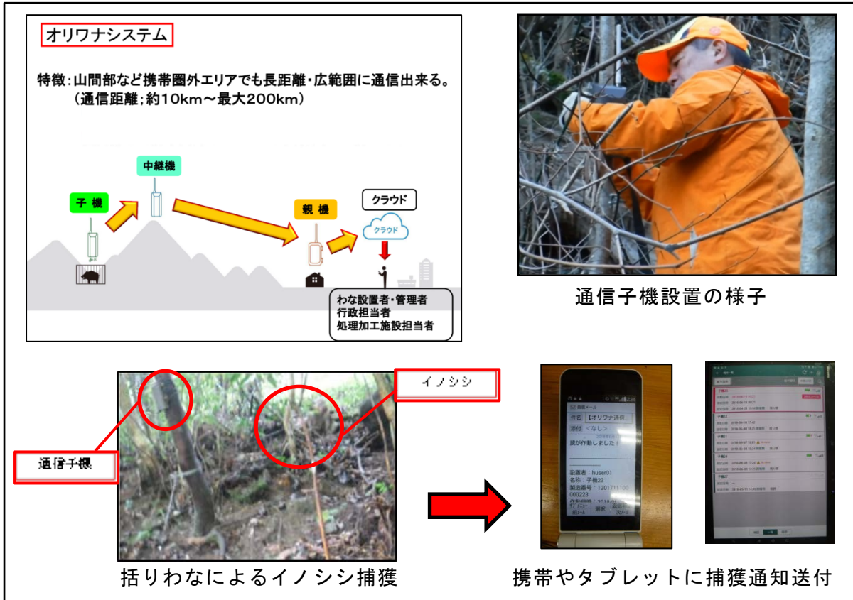
図2：簡易無線通信を利用した鳥獣捕獲通知システム
